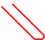
Z6 PODÉLNÁ UKONČOVACÍ VÝZTUŽ ROZDĚLOVACÍ VÝZTUŽE ZÁVĚRNÝCH ZÍDEK Ø12 á 100mm
